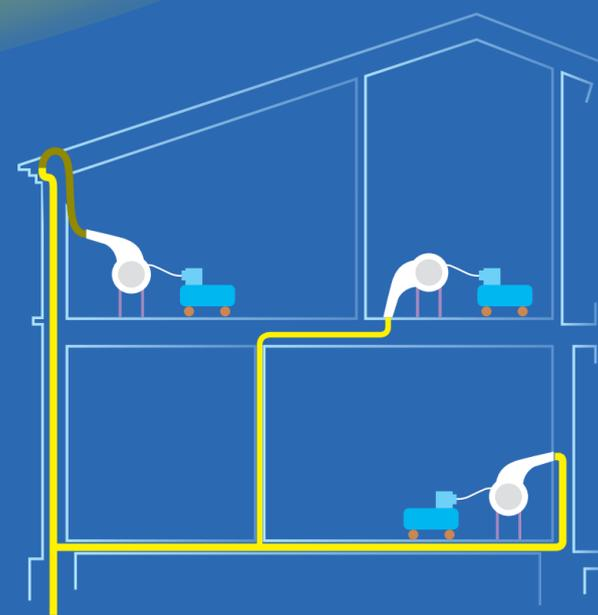
Sanierung der Abwasserleitungen mit dem Relining-Verfahren. Der Inliner wird mit einem Zweikomponenten-Epoxydharz imprägniert und anschliessend mit einem speziellen Inversierungsverfahren in die bestehende Leitung eingebracht. Unter Druck wird dieser bis zur vollständigen Polymerisation an die Rohrwand gepresst.
